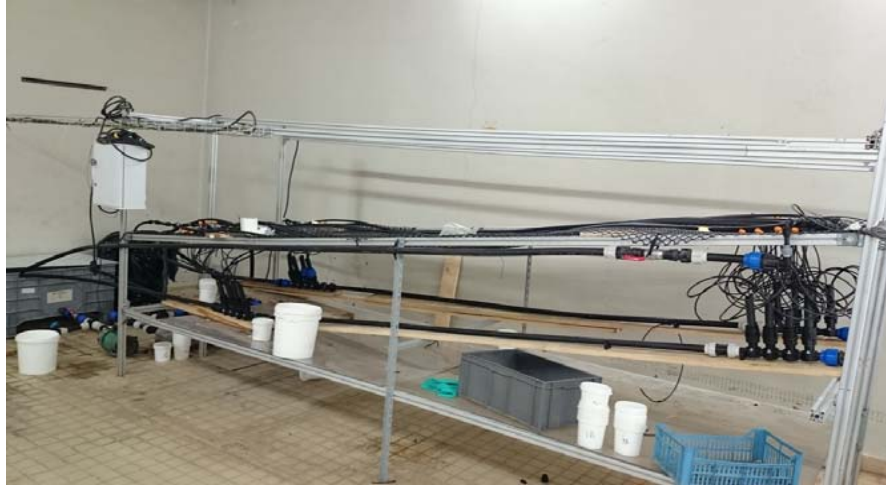
Banc analyses interaction colmatage biologique et colmatage chimique
