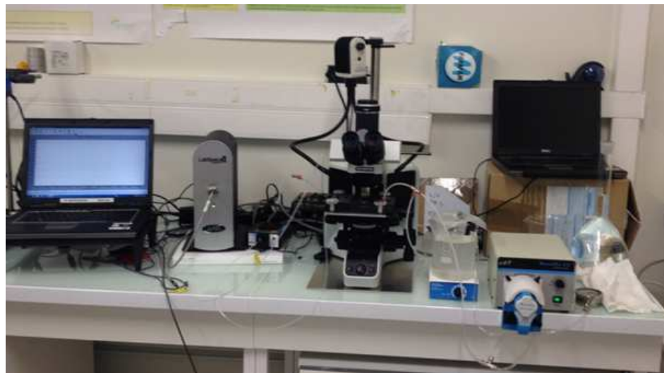
Spectromètre d'absorbance relié aux fibres optiques, pompe péristaltique et capteur de pression
