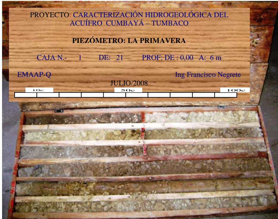
Figure 5. Exemple de photo des carottes témoins de perforation du piézomètre La Primavera (M303_1). Images provenant du rapport d'Arias (2008).
