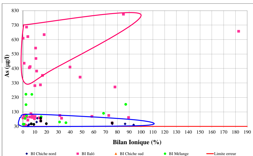
Figure 4.62. Relation As et bilan ionique au-dessus de la limite d'erreur instrumentale de l'EPMAPS. Les points noirs correspondent aux mesures faites à HSM positionnés à titre indicatif (pour plus de détails voir chapitre 3). Encerclés : bleu : forage C105 aquifère Chiche nord ; rose foncé : forage I106 aquifère Ilaló.
