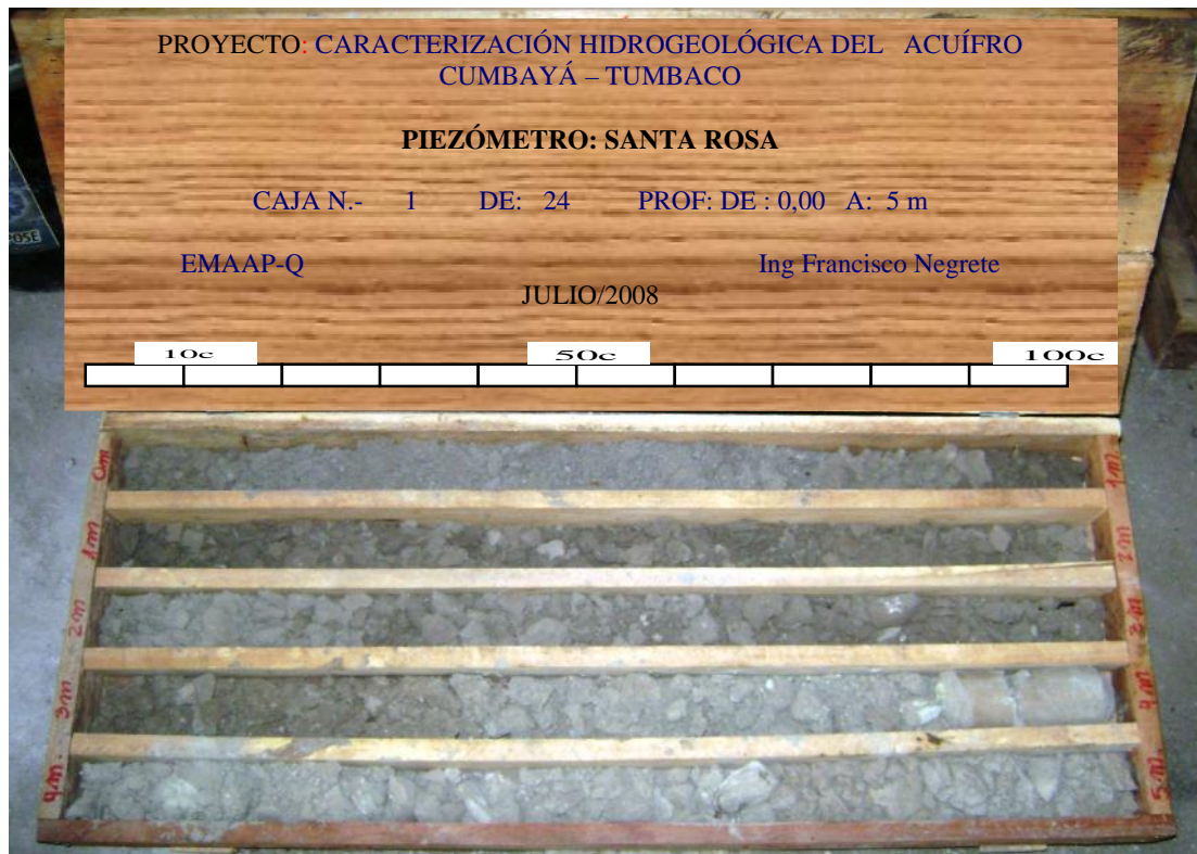
Figure 6. Exemple de photo des carottes témoins de perforation du piézomètre Santa Rosa (C107_1). Images provenant du rapport d'Arias (2008).
